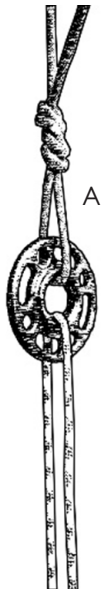
Figure 1. Déplacement: Une seule corde traverse l'ancrage dans une configuration de corde en mouvement.
