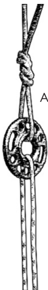
Figure 1. Déplacement: Une seule corde traverse l'ancrage dans une configuration de corde en mouvement.
