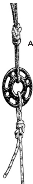
Figure 2. Stationnaire simple: Une seule corde attachée à l'aide d'un nœud en 8 simple dans une configuration de corde stationnaire.
